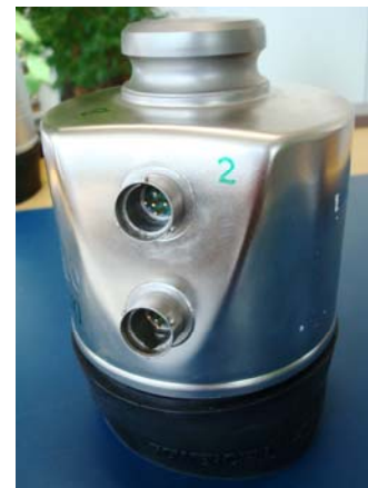
Connector plug load cells Anschluss-Stecker Lastwägezelle
