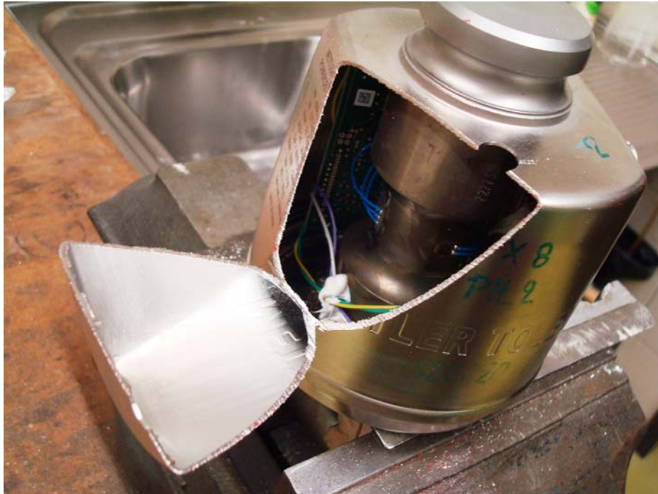
Enclosure open , no water penetrate Gehäuse offen , kein Wasser eingedrungen
