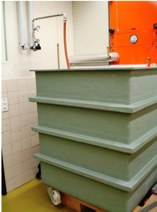
Water tank for continuous immersion Wasserbecken für das andauernde Untertauchen
