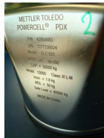
Rating label load cells Aufschriften Lastwägezelle
