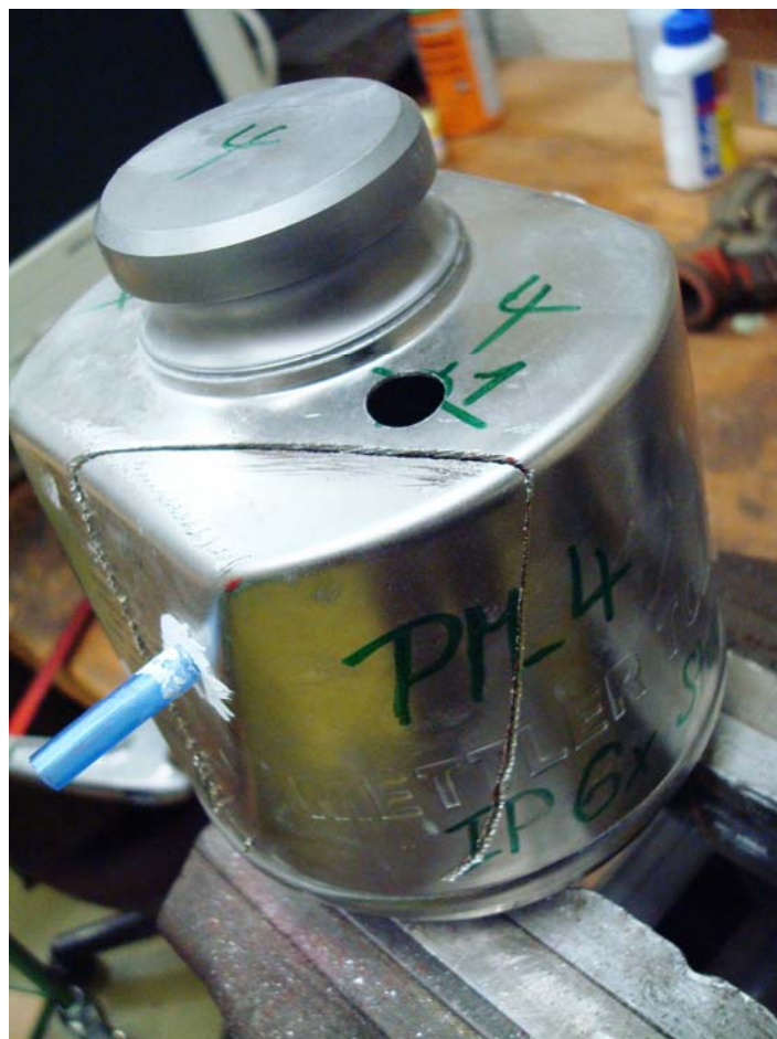
Enclosure to cut with probe hole Gehäuse aufgesägt mit Sondierloch
