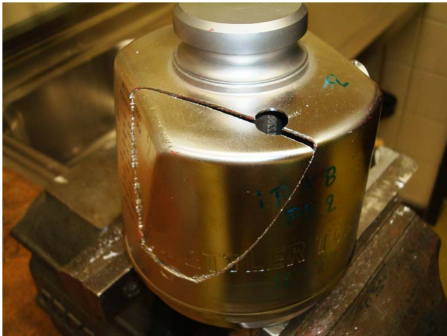
Enclosure to cut with probe hole Gehäuse aufgesägt mit Sondierloch
