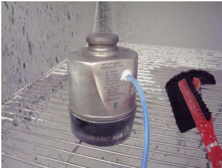
Arrangement after the dust test, after cleaning Geräteanordnung nach dem Staubtests, gereinigt
