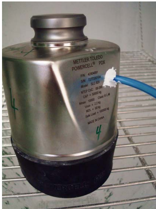
Arrangement of device under test in the dust chamber before the dust test Geräteanordnung in der Staubkammer vor der Staubprüfung
