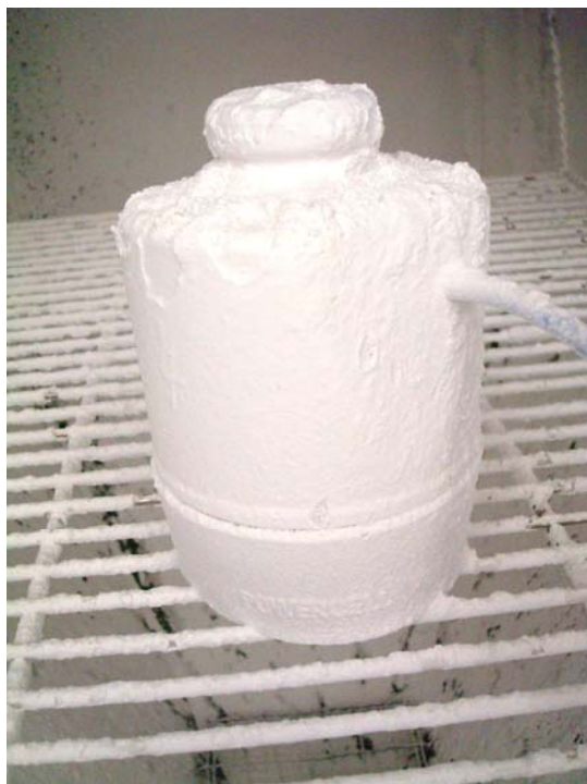
Arrangement of device under test in the dust chamber after the dust test Geräteanordnung in der Staubkammer nach der Staubprüfung
