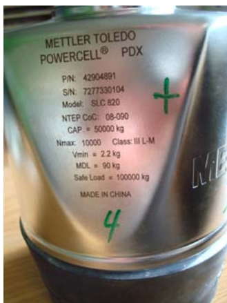
Rating label load cells Aufschriften Lastwägezelle
